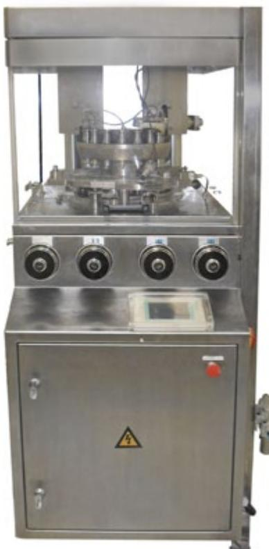
Compressoras de range médio, equipamentos robustos de fácil operação, confiáveis e seguros, possuem alimentação forçada.
