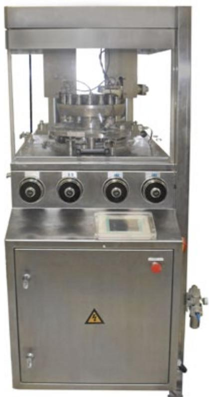
Compressoras de range médio, equipamentos robustos de fácil operação, confiáveis e seguros, possuem alimentação forçada.
