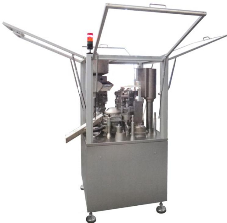
A transportadora de cápsulas CIMA CERTA 85F oferece a máxima versatilidade em termos da combinação de vários produtos na mesma cápsula o qual depende da configuração do equipamento e das unidades de dosificação instaladas.
