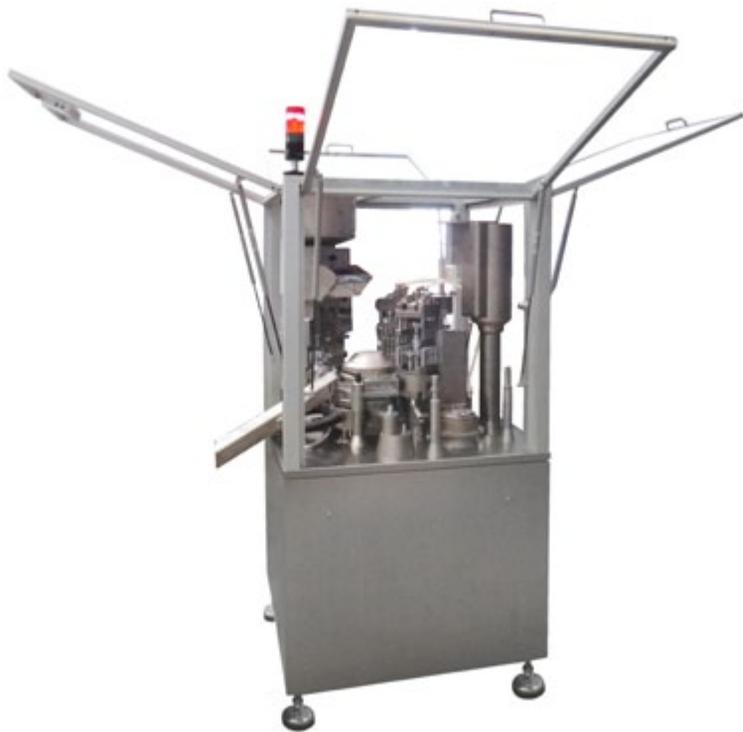
La llenadora de cápsulas CIMA CERTA 85F ofrece la máxima versatilidad en términos de la combinación de varios productos en la misma cápsula lo cual depende de la configuración del equipo y las unidades de dosificación instaladas.
