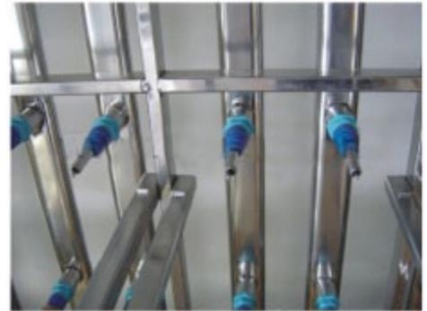
As válvulas de entrada e saída de ar fecham automaticamente quando uma caixa é removida, o rack pode trabalhar com 20% das caixas sem afetar as trocas de ar, velocidade e pressão no interior das caixas restantes.
