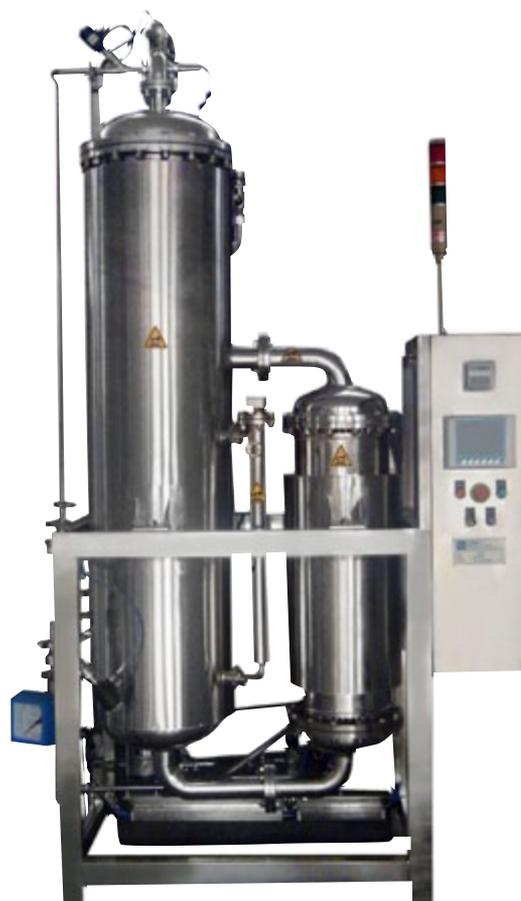
Este tipo de generadores de vapor puro se utilizan principalmente en autoclaves usadas en la industria farmacéutica y biotecnológica, para esterilizar recipientes y equipos usados en la producción de parenterales en sistemas SIP, etc.
